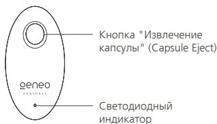
РИС. 3 Передняя сторона прибора Geneo Personal
