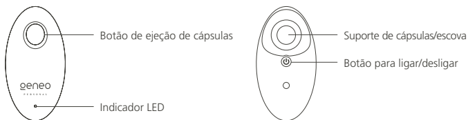
FIG. 3 Parte dianteira do dispositivo Geneo Personal
